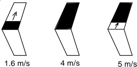
Die Empfindlichkeit der Balkenanzeige entspricht der Grunddämpfung des Varios (\* Set-Mode des Varios). Sie zeigt also immer das momentane Steigen an.
