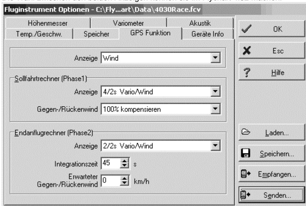
Im Flychart 4.32 ab Version .21 können sie diese Anzeige wechseln auf Gleitzahlanzeige. In der Gleitphase erscheint dann die Istgleitzahl abwechselnd mit dem Variointegrator.
